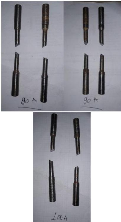
Gambar 1. Spesimen 80,90,100 A (1 dan 2) setelah di uji tarik
