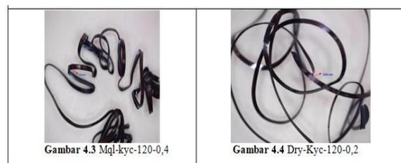
Gambar 3. Kondisi pemotongan MQL Kec. 120 laju pemakanan 0,4
