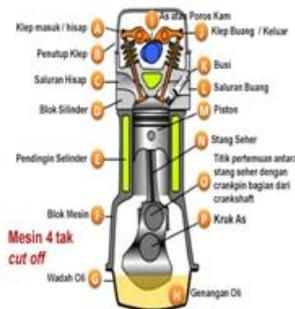
Gambar 1. Cara Kerja Sistem Motor 4 Langkah
