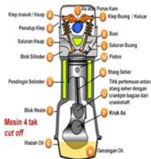
Gambar 1. Cara Kerja Sistem Motor 4 Langkah
