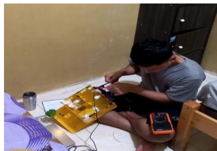
Gambar 4.6 pengujian nilai tegangan pada sensor LDR
